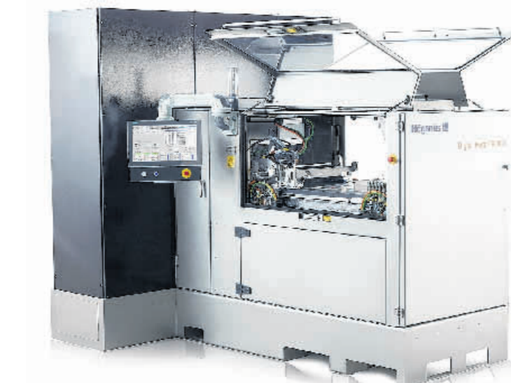
Flügelträger: Der Drucker P 2500 von Digital Metal arbeitet bei Raumtemperatur und benötigt keine Schutzgasatmosphäre. Foto: Digital Metal
